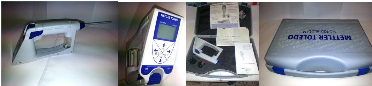
Il Densimetro modello Densito mostra il risultato in pochi secondi sia che stiate controllando la purezza dell'acqua o la qualità del vino o dell'olio. Il suo utilizzo è molto semplice: è sufficiente immergere il tubo di campionamento, premere il trigger e leggere il risultato finale direttamente nelle unità di misurazione che si desidera utilizzare. Completo di valigetta con manuale di istruzioni.
